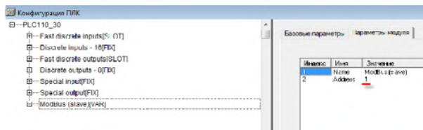
Рисунок 13.4 – Добавление и настройка элемента Modbus (Slave)
