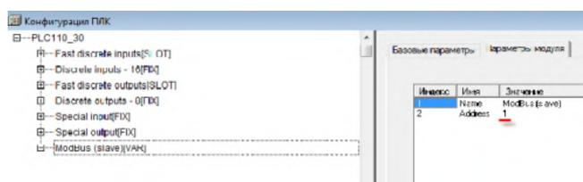
Рисунок 13.13 – Добавление и настройка элемента Modbus (Slave)
